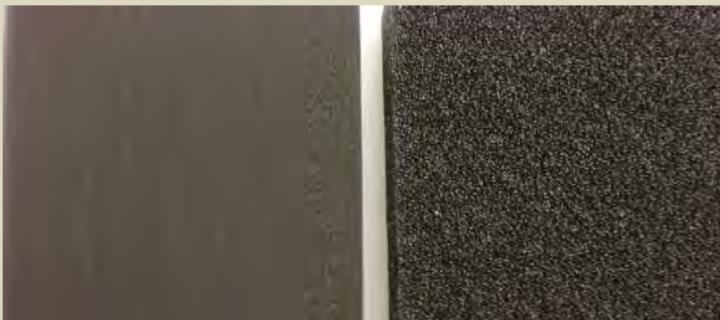
Schaumstoff für Schaftpolsterungen , retikuliert, anthrazit Raumgewicht 50 kg/m 3 , Dicke 3 mm Raumgewicht 100 kg / m 3 , Dicke 5 und 7 mm 2000 x 1000 mm VE Platte 14 91 003 - 007
